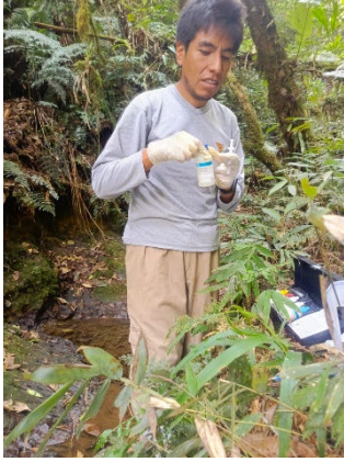
Fotografía 7. Medición de parámetros de campo, determinación de oxígeno disuelto con kit Hanna
