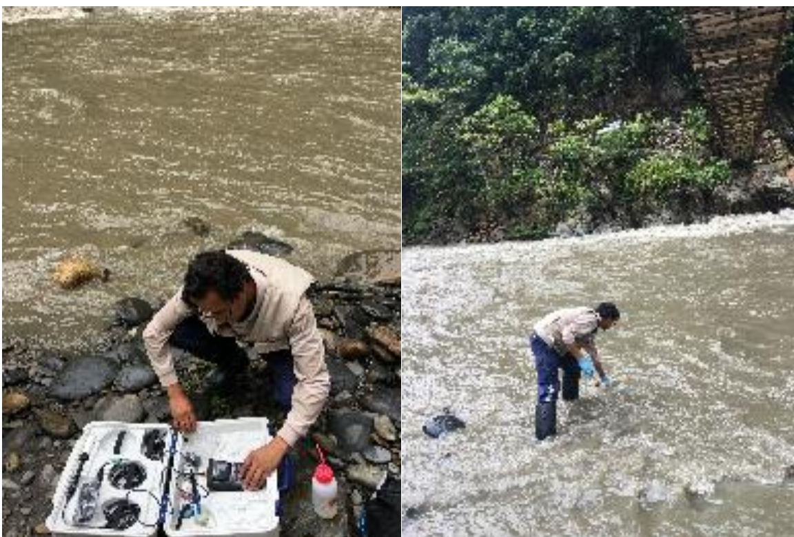
Figura 3. Calibración del equipo multiparamétrico utilizado y medición in situ de los parámetros fisicoquímicos en el río.
