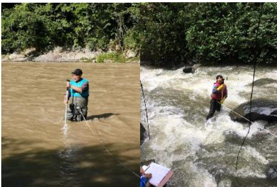
Figura 10. Toma de datos del caudal del río, mediante un velocímetro digital.
