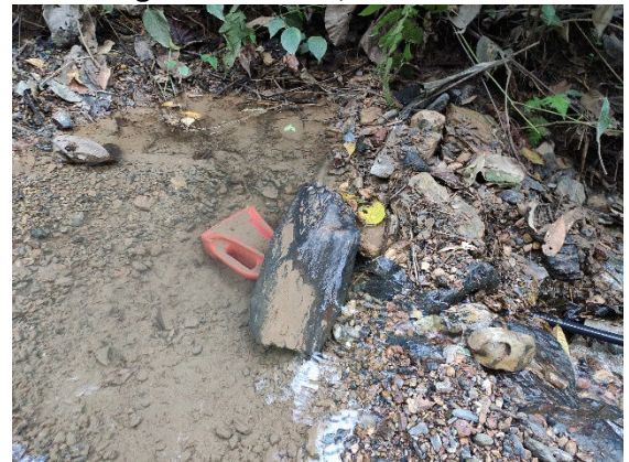
Fotografía 4. Captación con bidón y politubo sumergido a la fuente, sitio de muestreo
