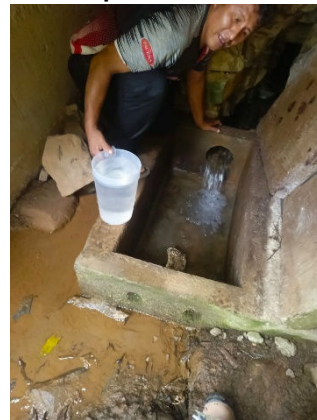
Fotografía 6. Medición de caudal por método volumétrico con representante de la comunidad
